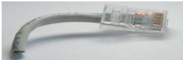
Slika 2. Kabl sa RJ45 konektorom
